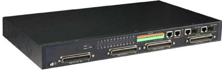
Благодаря сетевым uplink-интерфейсам Gigabit Ethernet (GE), IP DSLAM DAS-3224/3248 обеспечивают экономически эффективное решение для прямого подключения к IP-сетям через Интернет-маршрутизатор или коммутатор LAN.
